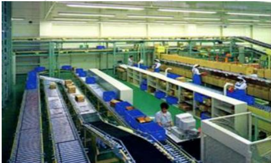
图10.6 配送中心分流货物的分拣线
