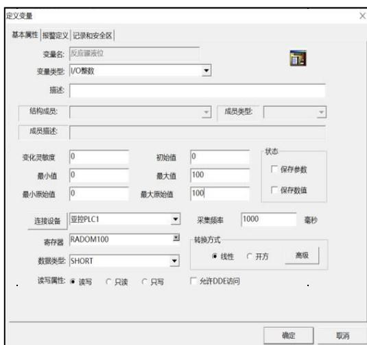
“反应罐液位”的变量属性设置如下：主要设置其基本属性，I/O 整型变量，连接亚控仿真 PLC，读取 RADOM100 寄存器的值，变量最小值为 0，最大值为 100。
