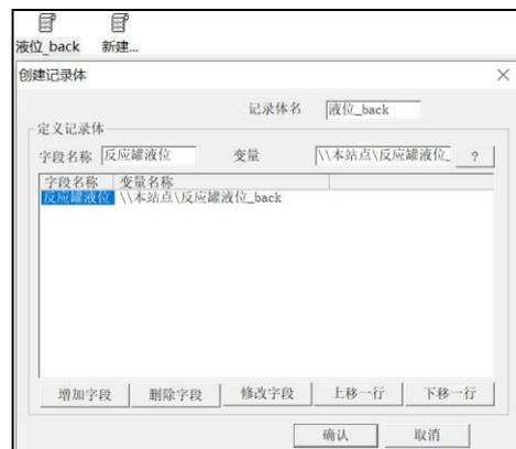
记录体“液位\_back”（该记录体用于从数据库相应字段中获取数据，并反映到所关联的变量中），并为该记录体增加字段“反应罐液位”关联新建变量“反应罐液位\_back”。
