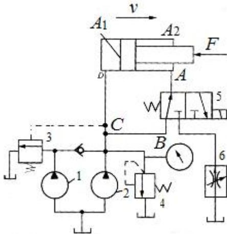
二、如图所示的液压系统，可以实现快进—工进—快退—停止的工作循环要求，说出图中标有序号的液压元件的名称。
