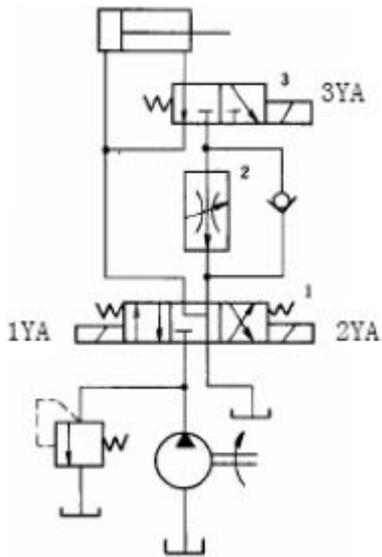
三、如图所示液压系统可实现快进—工进—快退—原位停止工作循环，写出元件 2、3、4、5、7、8、10、11、12 的名称
