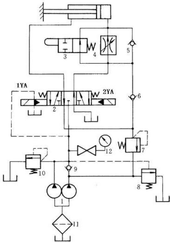
四、如图所示系统可实现“快进→工进→快退→停止（卸荷）”的工作循环。指出液压元件 1~4 的名称。
