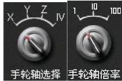
图 1-8 选择坐标轴与倍率旋钮
