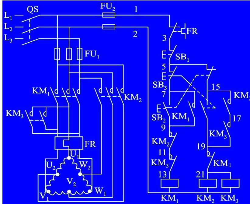
行程控制 见参考文档 2\_1-4\_2 三相异步电动机基本控制电路
