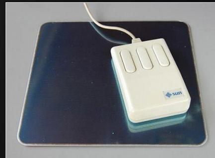
最早的鼠标拥有两个轮子和木头的外壳，只可以在水平和垂直方向运动。但是显然这样X-Y坐标系并不能满足人们的需求，随后就出现球形结构代替X-Y坐标系，这大大的方便了人们的使用。后来人们发现很多鼠标拥有滚球结构，但是灰尘和污垢很容易堵塞内部，1981年，Steven Kirsch 为鼠标系统开发了一款光学模型。这些鼠标利用光线代替滚球去跟踪移动。不过想要它正常工作，人们需要配一个鼠标垫。
