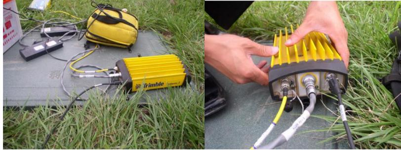
●开机后接收机的有关指示和仪表数据显示正常时，方能进行自测试和输入有关测站和时段控制信息。
