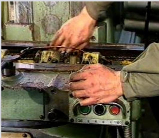
检查、清洗内部零件及油路
