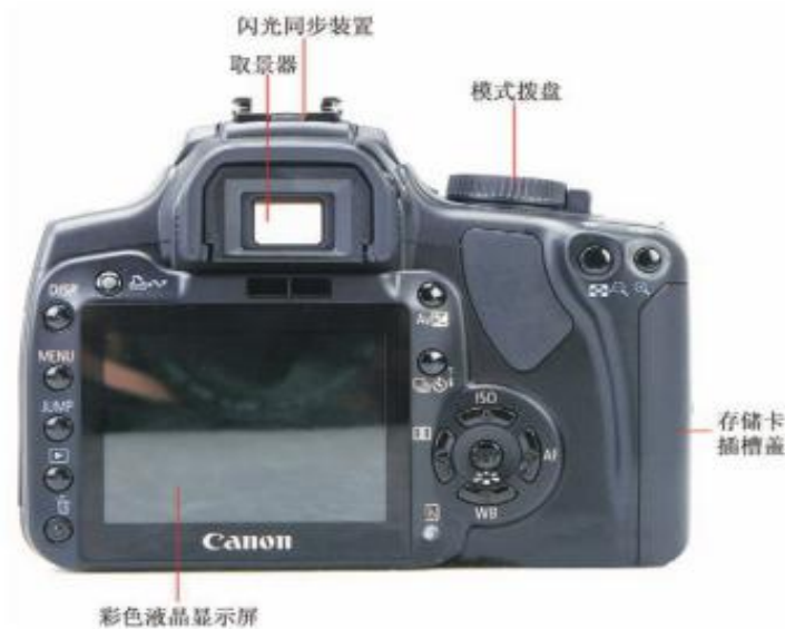
图1-1-7 数码单反照相机的结构（背面）
