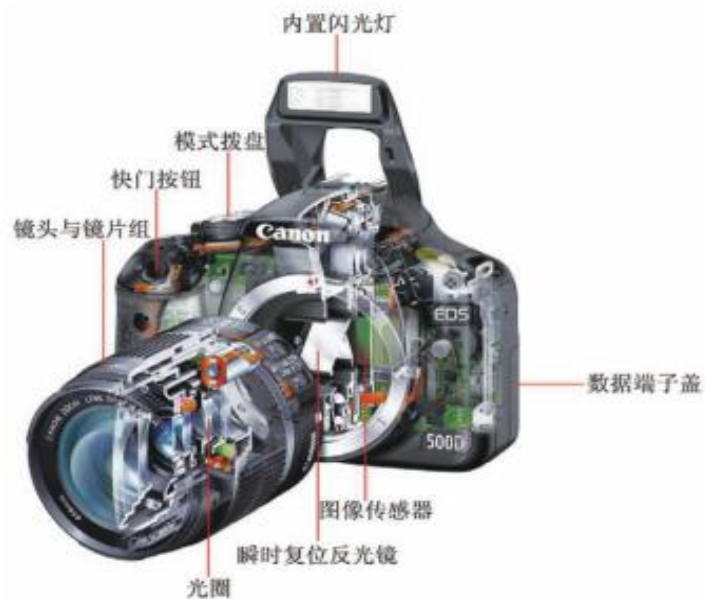
图1-1-6 数码单反照相机的结构（正面）
