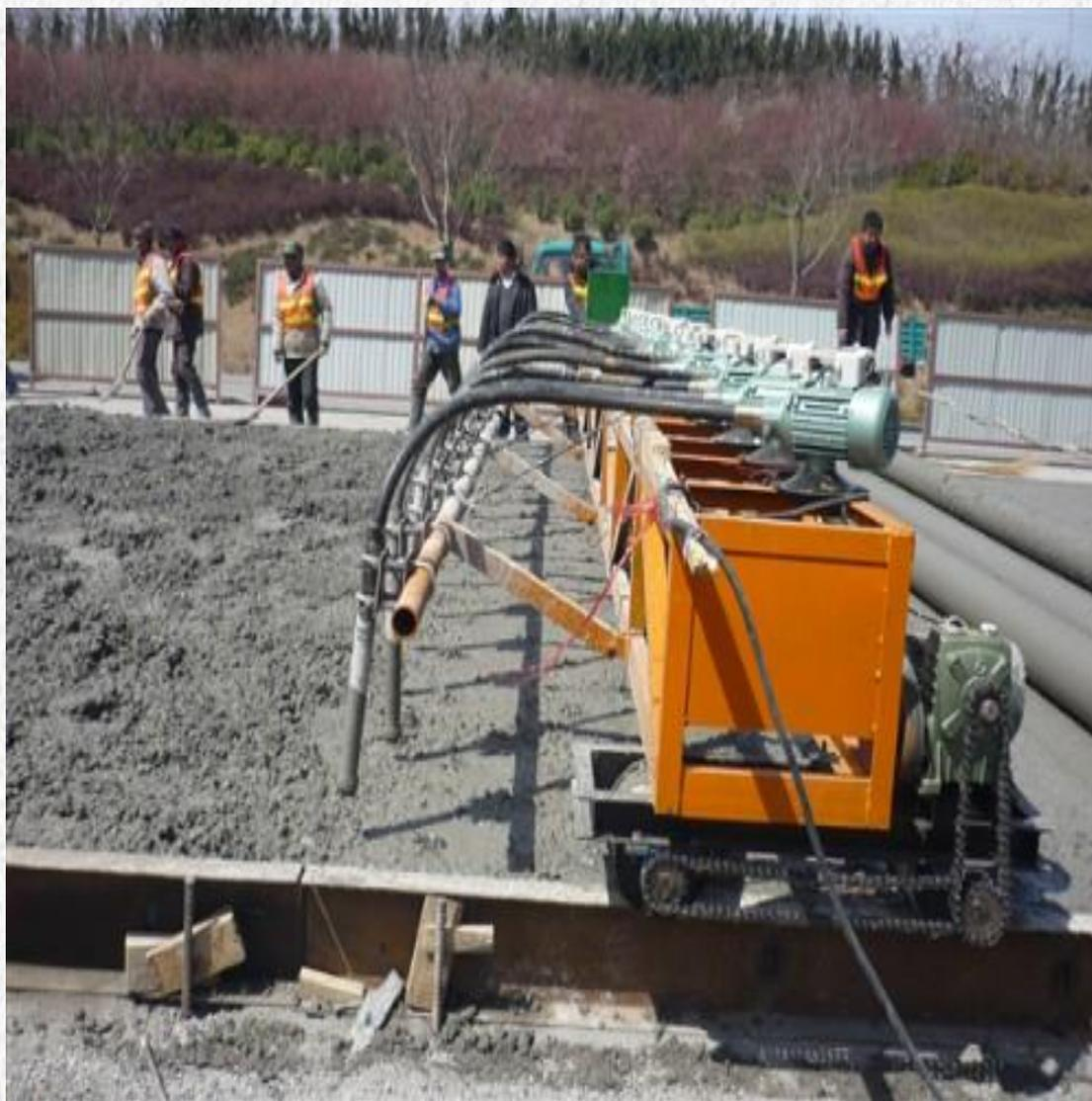
图6-4 密集排列振捣棒的振捣机
