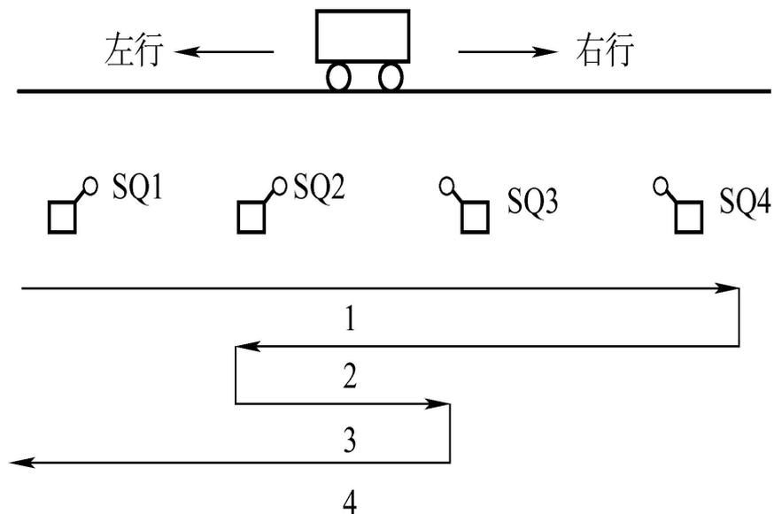
左图为生产流水线的小车运动示意图。小车在一个周期内的运动由4段组成。假设小车最初在左端，压下限位开关SQ1，当按下起动按钮，则小车自动循环地工作；若按下停止按钮，则小车完成本次循环后停止在初始位置。
