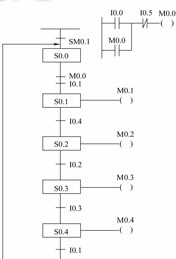
设S0.0为初始步，小车运动过程的4段分别对应S0.1~S0.4所代表的4步。初始化脉冲SM0.1将初始状态S0.0置位。
