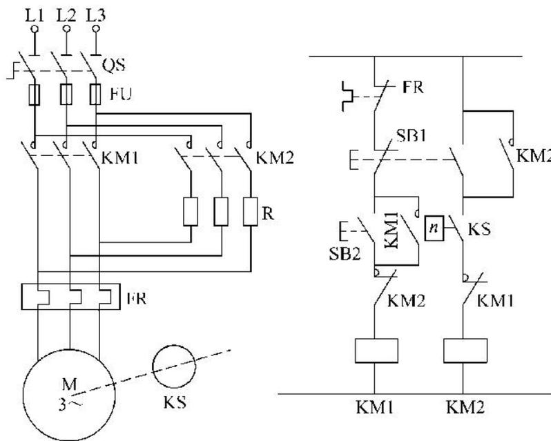
按下起动按钮**SB2** →接触器**KM1**通电并自锁→电动机**M**通电→速度继电器**KS**的常开触头闭合，为反接制动做好了准备。
