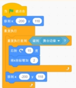
为了使足球走到最右边后返回起点，可以重复游戏，加上重复执行
