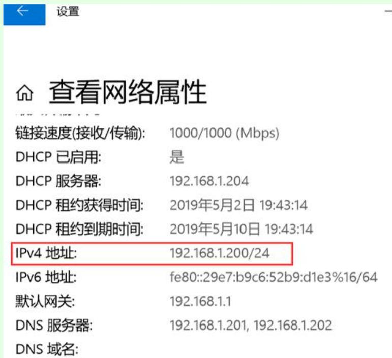
对于 PC3 部门主管计算机，我们换一种方式来测试。在命令行输入 ipconfig /release，释放之前获取的 192.168.1.103，然后在输入 ipconfig /renew，重新获取 IP。
