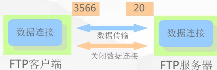
双方进行数据传输。传输完毕后发送数据的一方主动关闭数据连接
