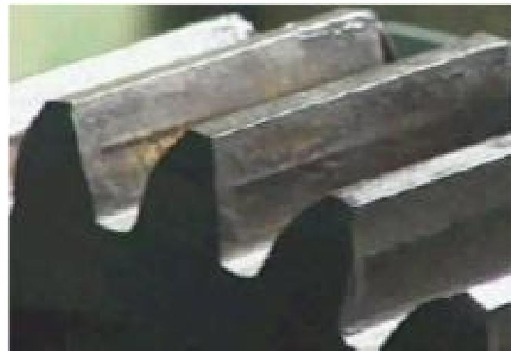
**防止塑性变形的措施：提高齿面硬度；增大润滑油粘度。**
