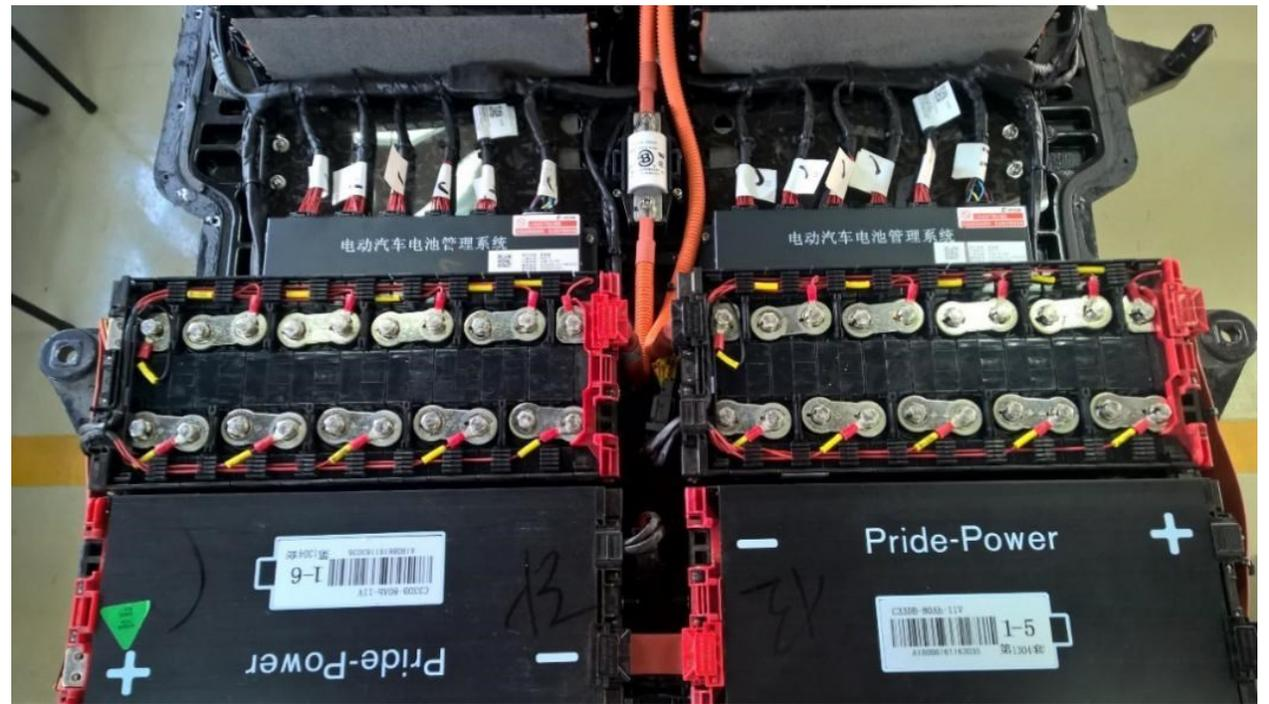
电芯电压检测接点
