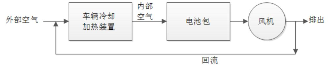
主动加热与散热-外部和内部空气流通
