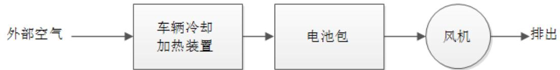
被动加热与散热-外部空气流通
