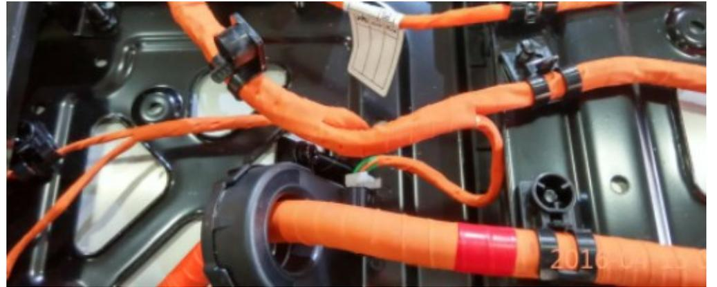
套装在母线上的霍尔电流传感器
