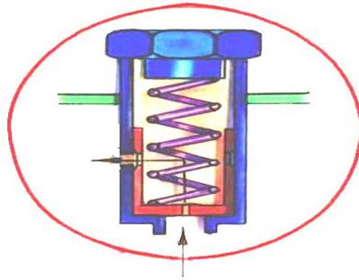
作用:一旦滤清器发生杂质淤塞,进油与出油道中的压力差达  $0.15\sim 0.18\text{MPa}$  时,该阀打开,机油不经滤清器直接进入主油道,保证对各部件的润滑。
