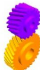
外啮合斜齿圆柱齿轮传动
