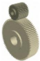
外啮合直齿圆柱齿轮传动
