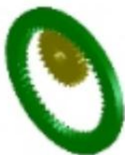
内啮合直齿圆柱齿轮传动
