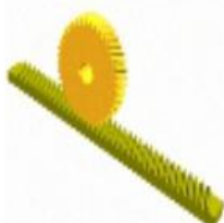
齿轮齿条传动 (斜齿条)
