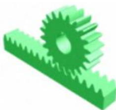
齿轮齿条传动 (直齿条)
