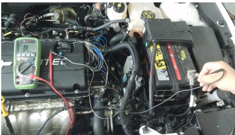
图5-36 低电平参考电压电路检查
