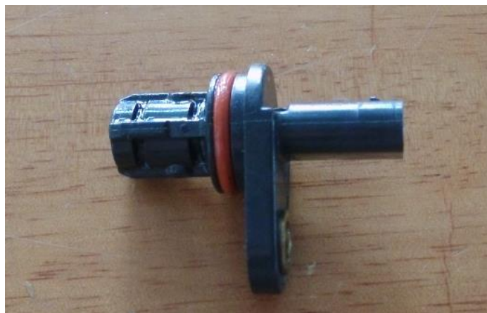
图 5-34 排气凸轮轴位置传感器实物图
