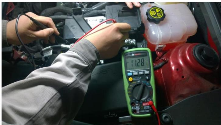
图 1-30 用万用表检测电压
