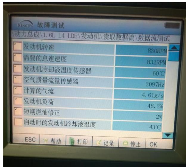
图 1-33 用检测仪读取动态数据流
