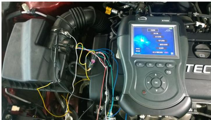
图 1-34 准备读取空气流量计数据流
