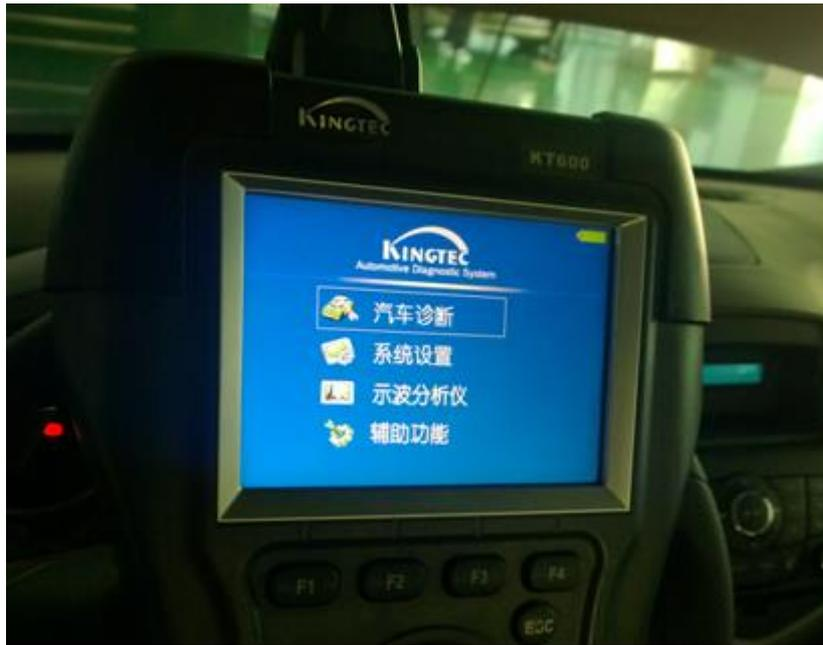
图 1-32 用检测仪读取故障码
