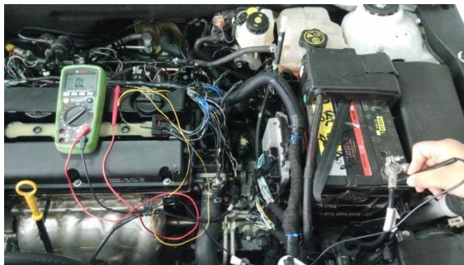
图 5-58 搭铁电路检查
