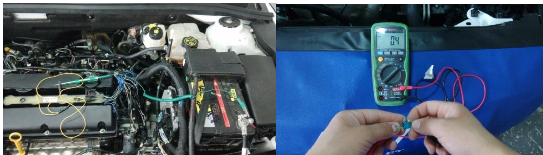
图 5-61 点火电压电路及保险丝检查
