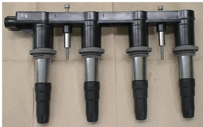
图 5-56 点火线圈实物图
