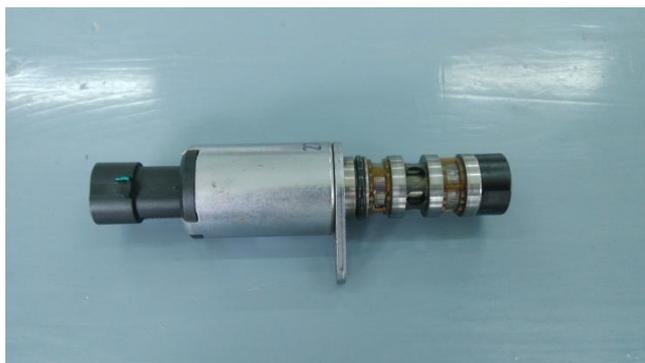
图 5-15 进气凸轮轴位置执行器电磁阀实物图
