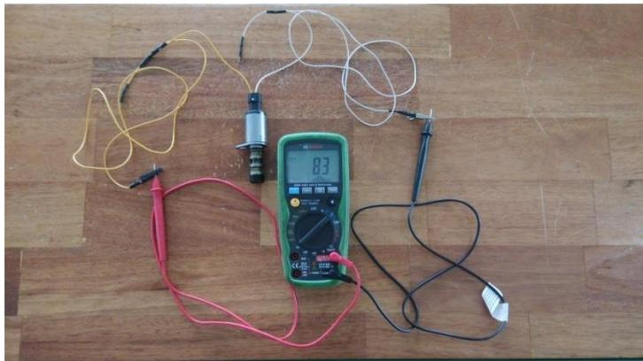
图 5-23 Q6F 进气凸轮轴位置执行器电磁阀检查
