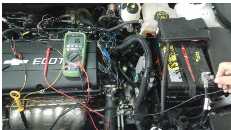
图 5-19 搭铁电路检查
