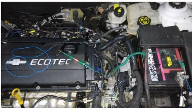
图 6-55 点火电压电路检查
