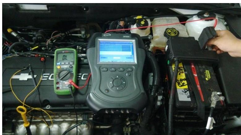
图 5-20 控制电路检查
