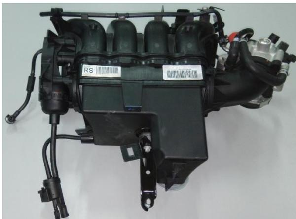
图 6-53 进气歧管调节电磁阀
