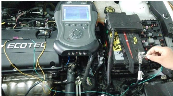
图5-26 K20发动机控制模块检查
