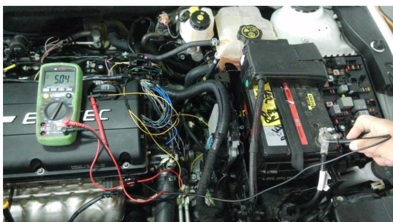
图5-23 5V参考电压电路检查
