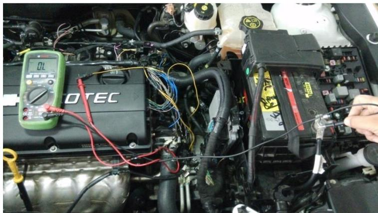
图5-19 低电平参考电压电路检查
