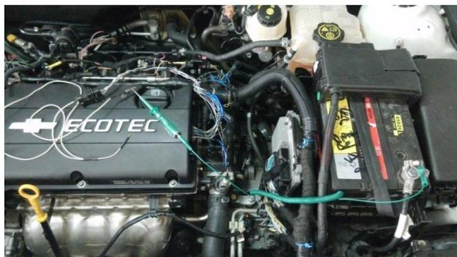
图 6-18 点火电压电路检查
