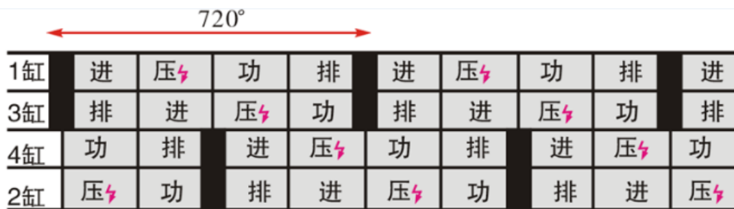
图 4-16 分组喷射正时图
