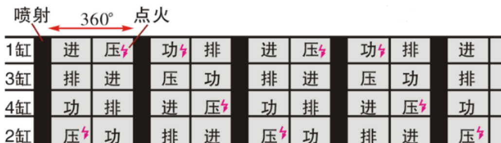
图 4-14 同时喷射正时图
