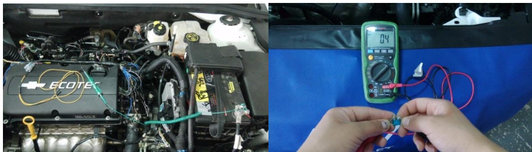
图 4-21 点火电压电路及保险丝检查
