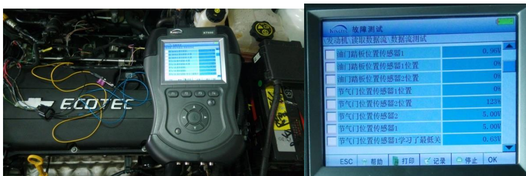
图3-65 节气门位置传感器1信号电路检查
