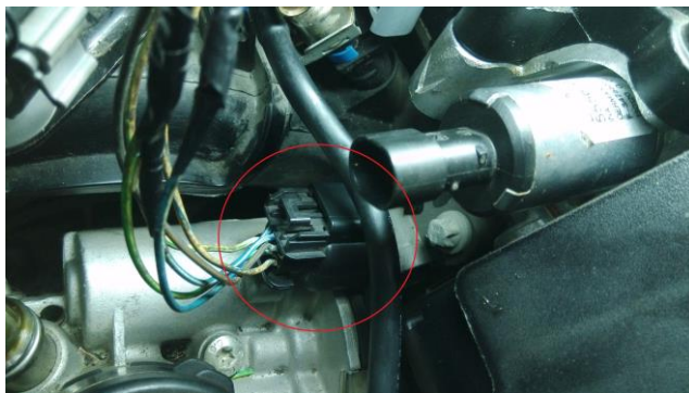
图3-56 Q38节气门体处的线束连接器
