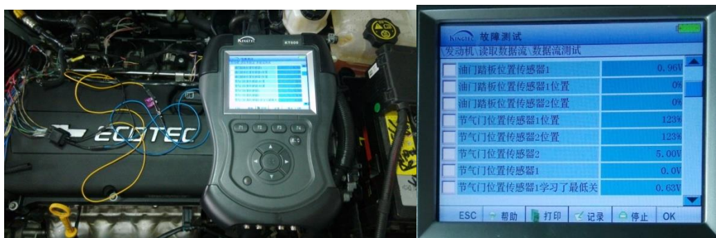
图3-63 节气门位置传感器1信号电路检查
