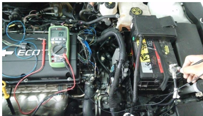
图3-59 低电平参考电压电路检查
