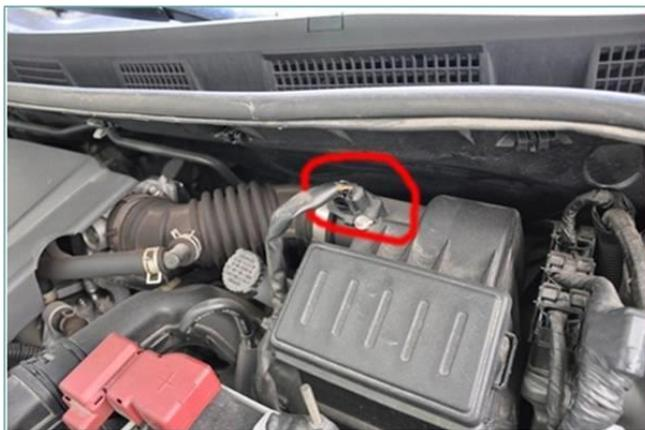
图 3-1 空气流量计实物图
