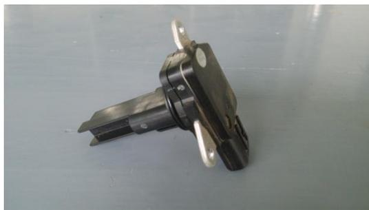
图 3-2 热线式空气流量计实物图
