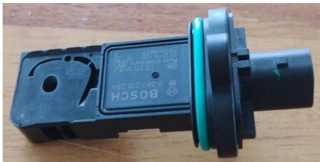
图 3-14 热膜式空气流量计实物图
