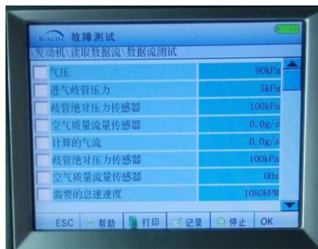
图3-43 进气歧管绝对压力传感器失真检查
