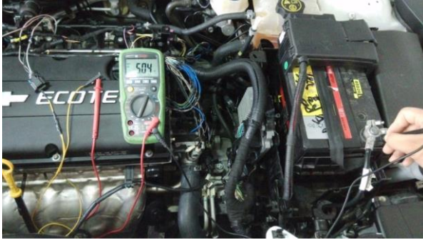
图3-40 5V参考电压电路检查
