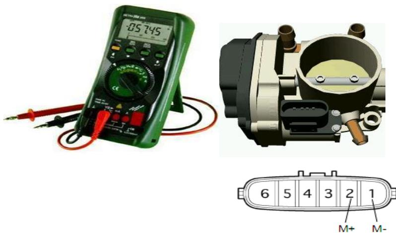
图 2-5-2 丰田卡罗拉 1ZR 发动机怠速控制装置检测
