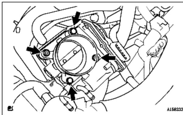
(3) 拆下2个螺栓、2个螺母和节气门体总成；
