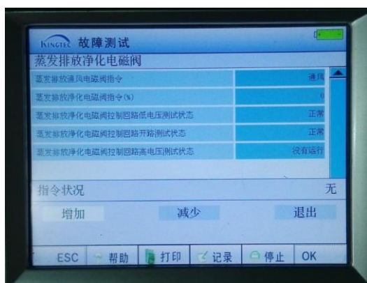
图 6-14 控制电路检查
