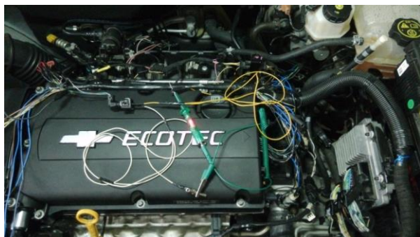
图 6-12 控制电路检查
