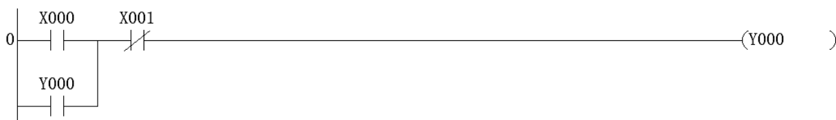
图 5-1 机床工作指示灯控制梯形图
