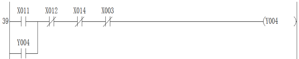
图 5-9 冷却泵电动机的控制梯形图
