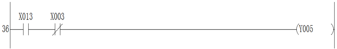
图 5-8 快速移动电机的控制梯形图
