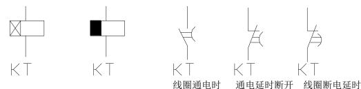
通电延时线圈 断开延时线圈 延时闭合常开触头 常闭触头 闭合的常开触头
