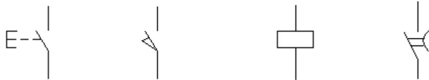
带动合触点的按钮、位置开关的动合触点、继电器线圈、延时闭合动合触点
