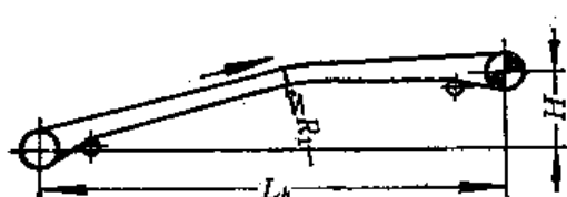
图 2-1-3 带凸弧段输送机
