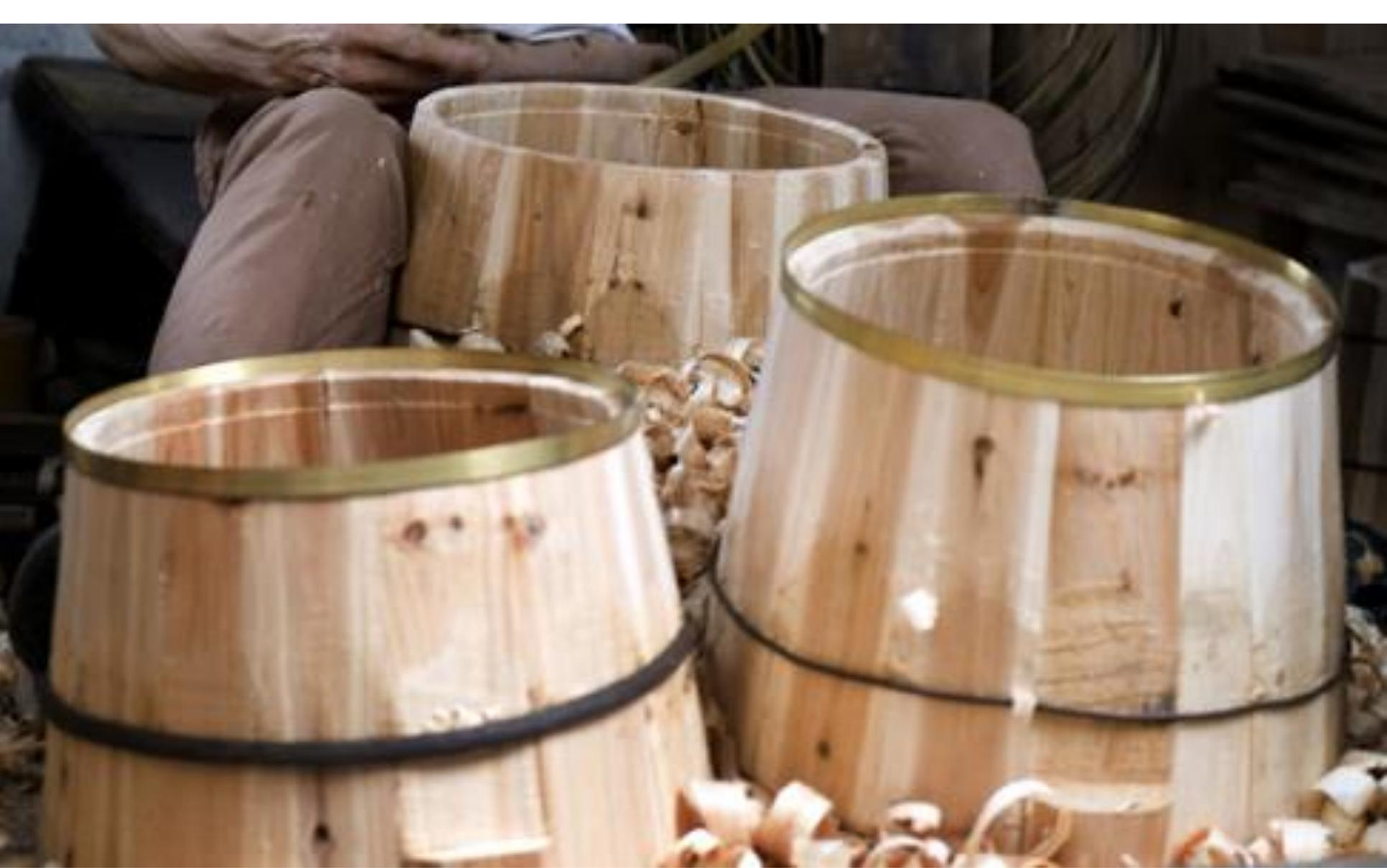
用预应力原理让铜箍将木片捆制成木水桶
