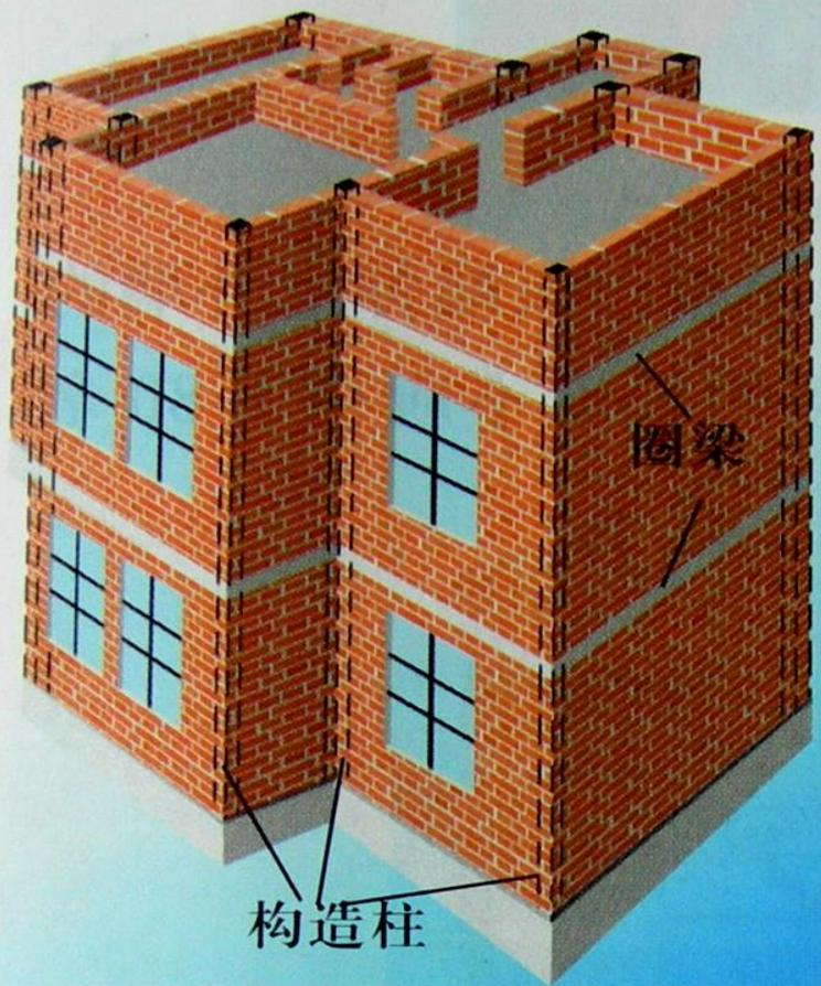
图 10 构造柱的设置
