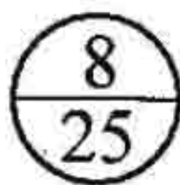
图 2.0.19 详图和被索引图样不在 同一张图纸内的表示方法
