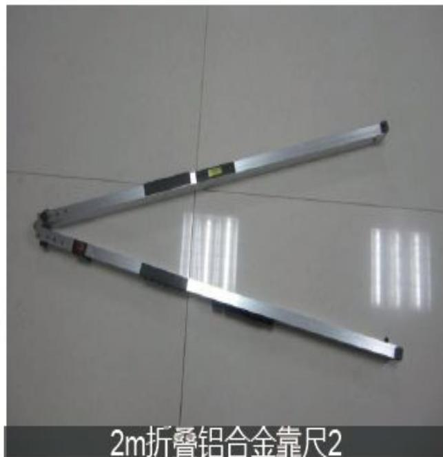
用途：用于测量墙、地面的平整度及垂直度的仪器
