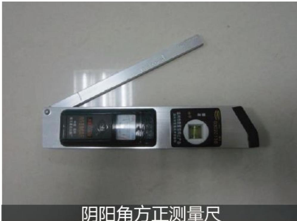
用途：用于墙体的阴阳角方正度测量仪器
