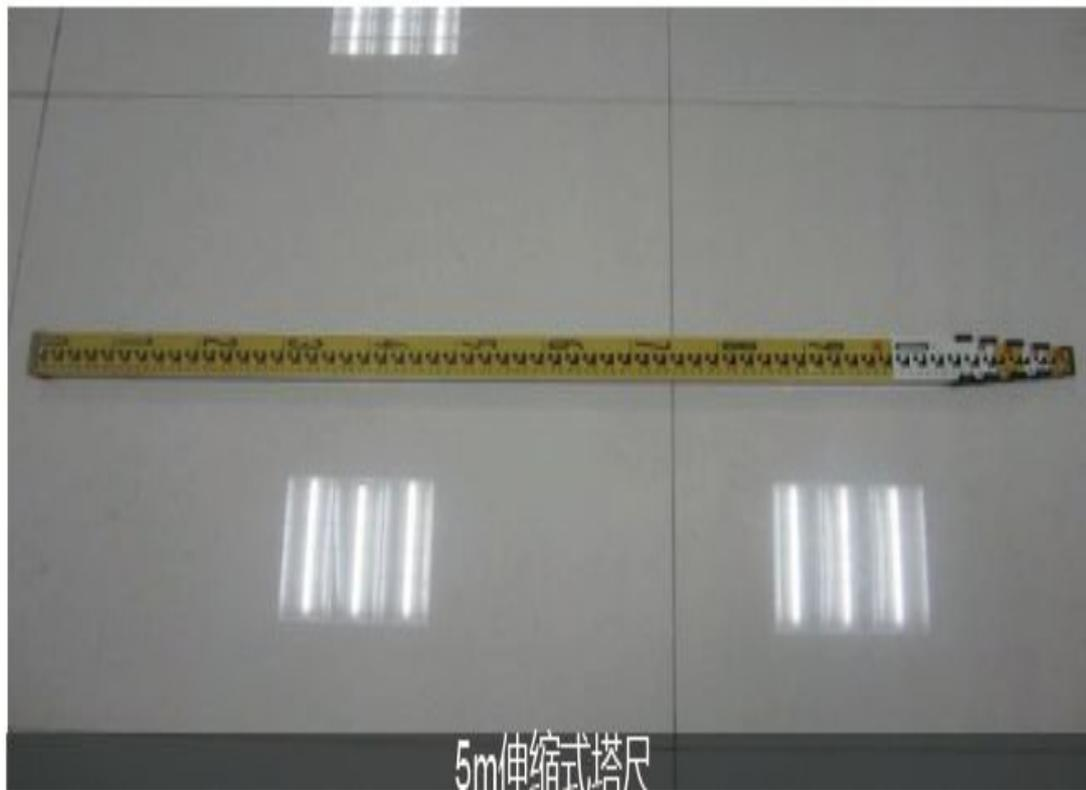
用途：配合测量标高尺寸的测量仪器
