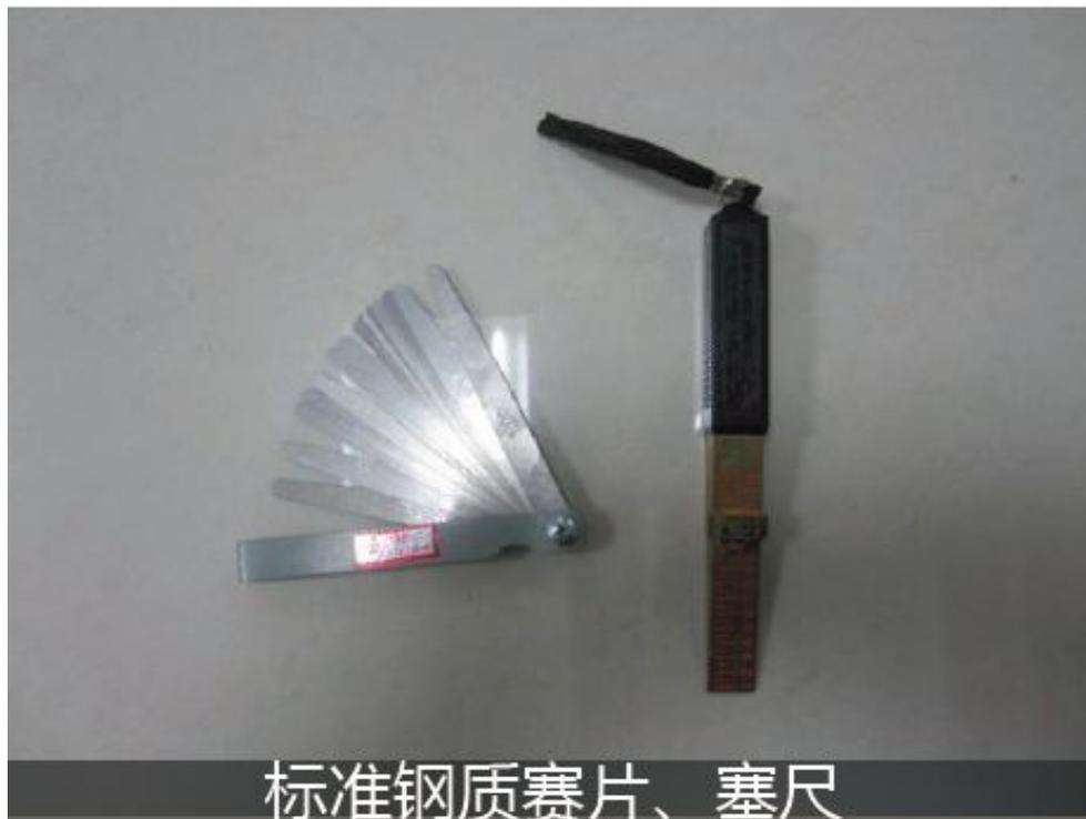
用途：用于测量缝隙大小或配合测量平整度的测量仪器
