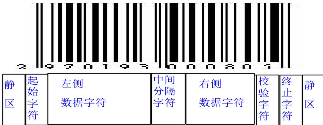
图 2-5 出了一个条形码的完整结构
