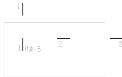
图7.1.2 断面的剖切符号
