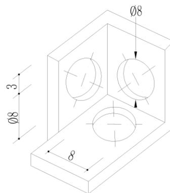
图 10.5.5 轴测图圆直径标注方法
