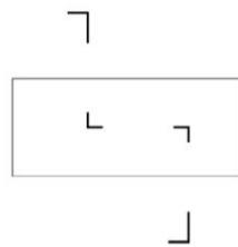
图 10.3.2-2 两个平行的剖切面剖切
