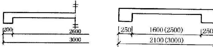
图 11.7.4 对称构件尺寸标注方法
