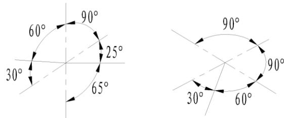
图 10.5.6 轴测图角度的标注方法
