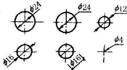
图 11.4.5 小圆直径的标注方法
