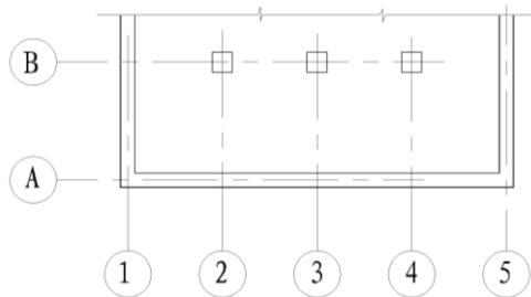
图 8.0.3 定位轴线的编号顺序
