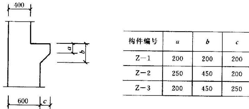
图 11.7.6 相似构配件尺寸表格式标注方法
