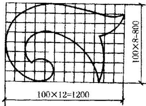
图 11.6.5 网格法标注曲线尺寸
