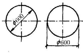
图 11.4.4 圆直径的标注方法
