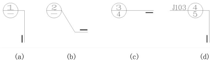
图 7.2.2 用于索引剖面详图的索引符号
