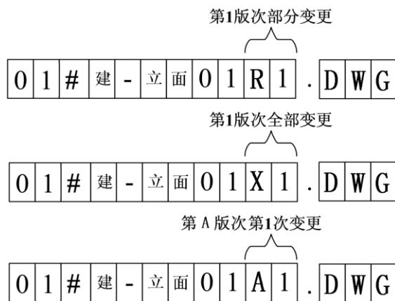
图12.3.2-2 工程图纸文件变更表示方式
