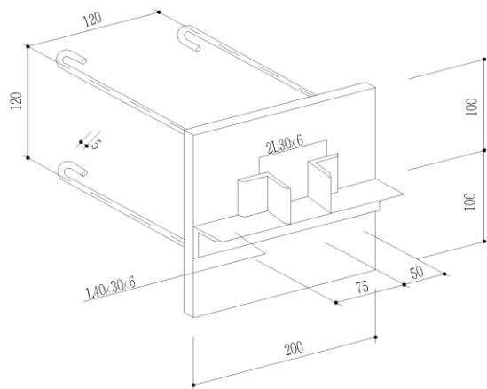
图 10.5.4 轴测图线性尺寸的标注方法
