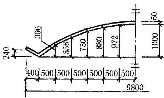
图 11.6.4 坐标法标注曲线尺寸
