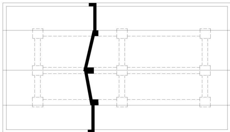
图 10.3.4-3 断面图画在布置图上
