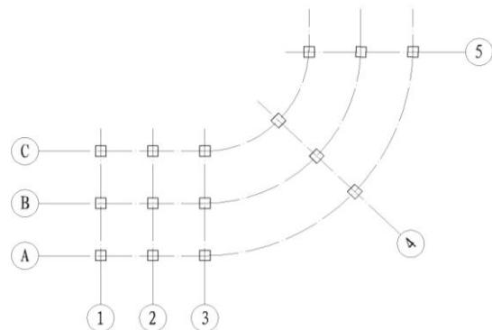
图 8.0.9-2 弧形平面定位轴线的编号
