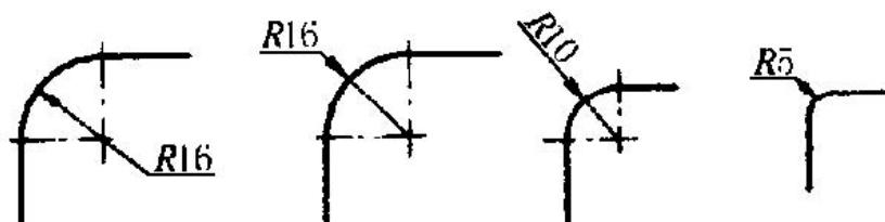
图 11.4.2 小圆弧半径的标注方法
