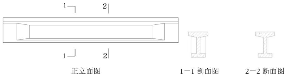
图 10.3.1 剖面图与断面图的区别
