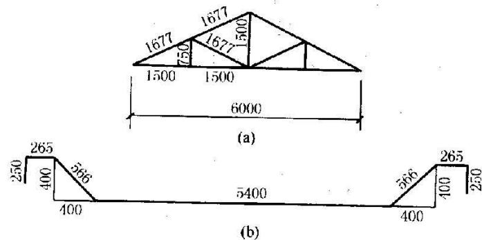
图 11.7.1 单线图尺寸标注方法
