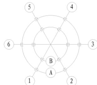
图 8.0.9-1 圆形平面定位轴线的编号
