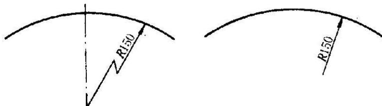
图 11.4.3 大圆弧半径的标注方法
