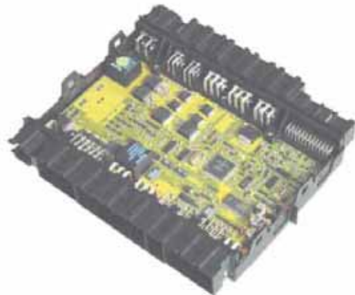
“途锐”所使用的车载电网控制单元 J519 S234_043
